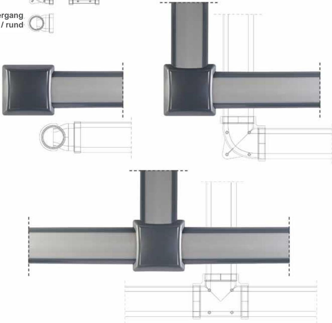
Die Eckabdeckung für die Saugrohre ermöglicht Ihnen den Anschluss von max. drei Saugleitungen, abhängig von der Verwendung eines T-Stückes oder eines 90° Bogens lang.
